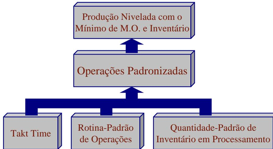
**Fig. 7 – Componentes da Operação Padronizada**
